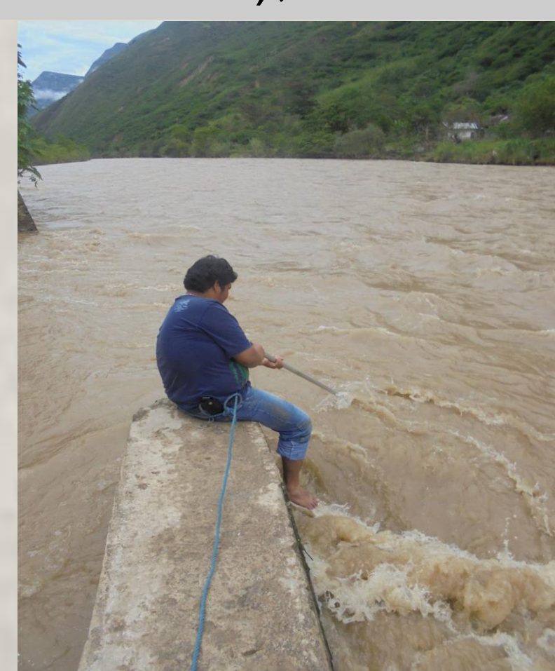
Foto 05: Toma de velocidades (m/s) en el río Utcubamba.
