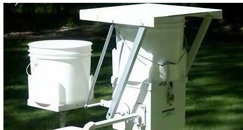
Figura 3. Colector automático de deposición modelo ADS-120, de marca N-CON, con componentes de deposición húmeda y seca. Tomado de N-CON: https://www.n-con.com/Products/ads.html
