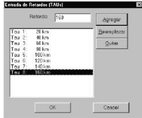
Después de ingresar el ancho del pulso del transmisor B (TXB) “*Pulse Width*” en el Panel del Controlador de Radar, se procede a habilitar la entrada de los retardos mediante el “*Check Box Delays*”. Inmediatamente, el botón <*Delay Entries*> quedará habilitado. Al presionar este botón aparece la ventana de diálogo para editar los retardos, tal como se muestra en la Figura 3.
