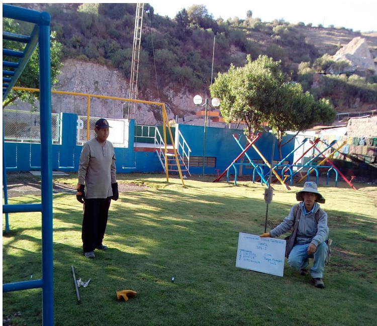
Figura 28: Ensayo de penetración dinámica ligera en el parque de niños de Torata, ubicado a 100 metros al este de la plaza principal de Torata. (DPL-01).
