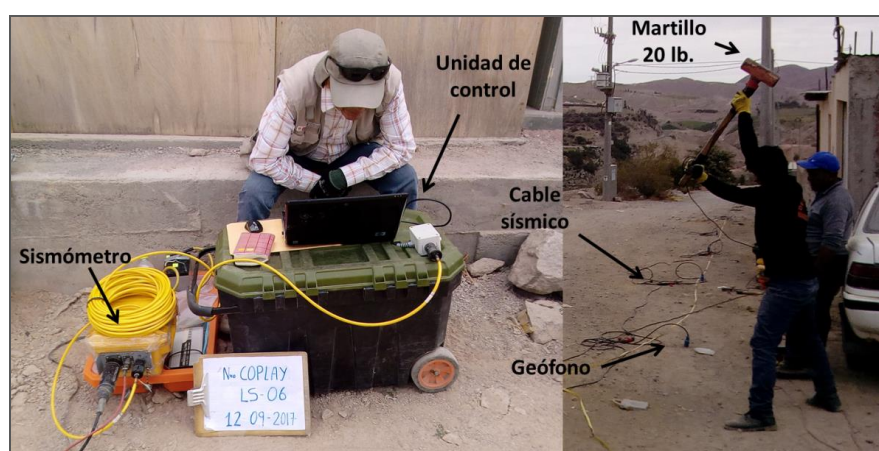
Figura 9: Equipo sísmico para la toma de datos de MASW en la Asoc. Taller Binacional.
