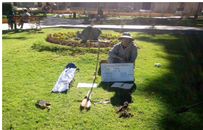
Figura 27: Ensayo con posteadora manual en la Plaza principal de Torata.
