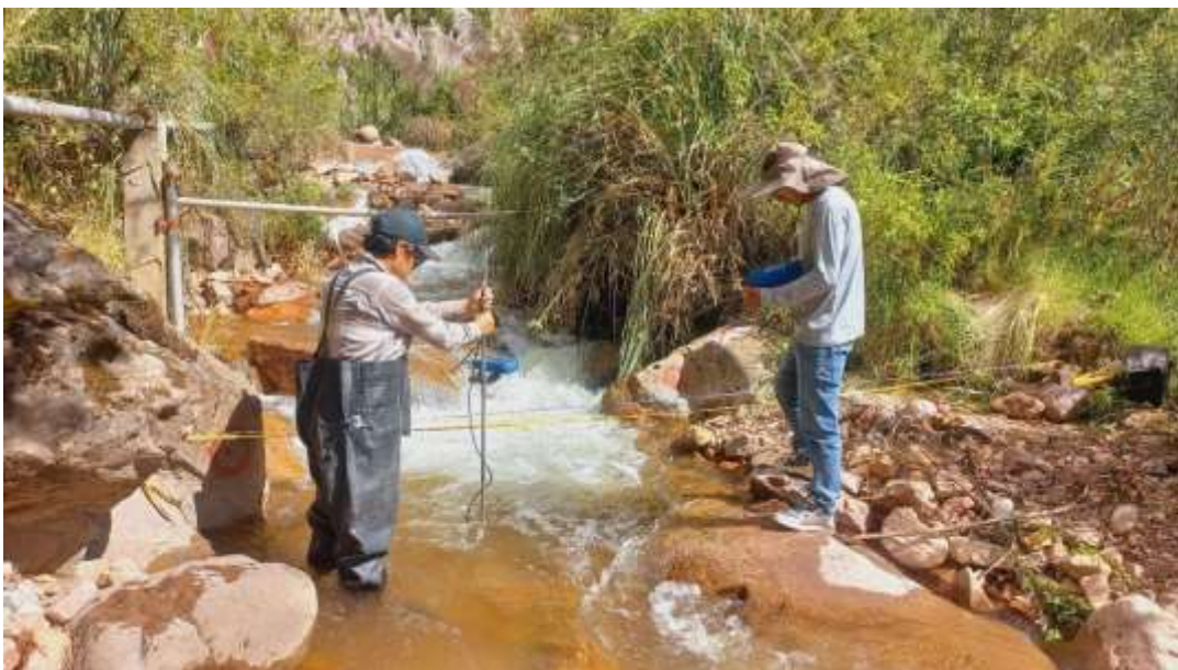
Fotografía n° 02: Aforo con correntómetro.
