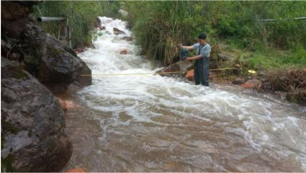
Fotografía n° 05: Aforo con correntómetro.
