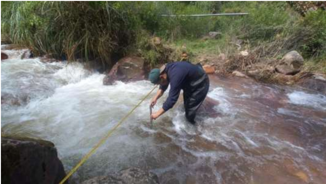
Fotografía n° 01: Mediciones de los tirantes en la sección del río.
