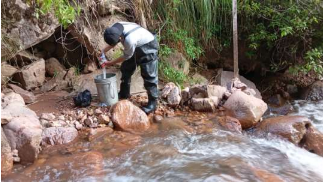
Fotografía n° 11: Preparación de la solución de 20 litros de agua con 4 kilogramos de sal.
