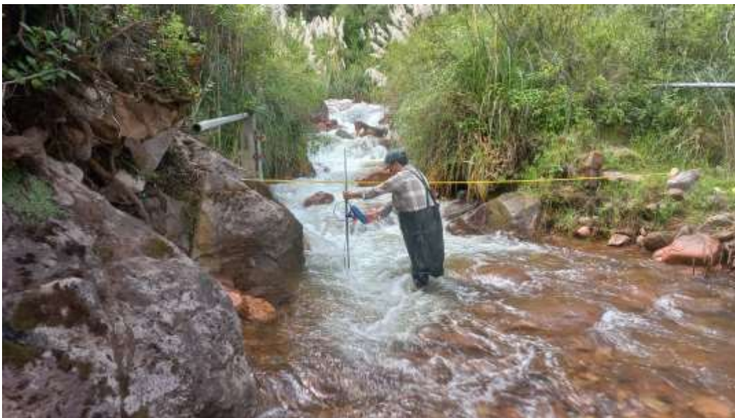
Fotografía n° 06: Aforo con correntómetro.
