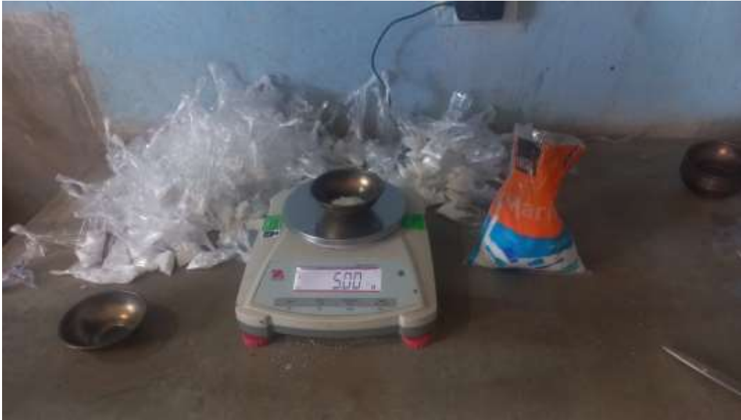
Fotografía n° 07: Medición de los 5 gramos de sal para la calibración.
