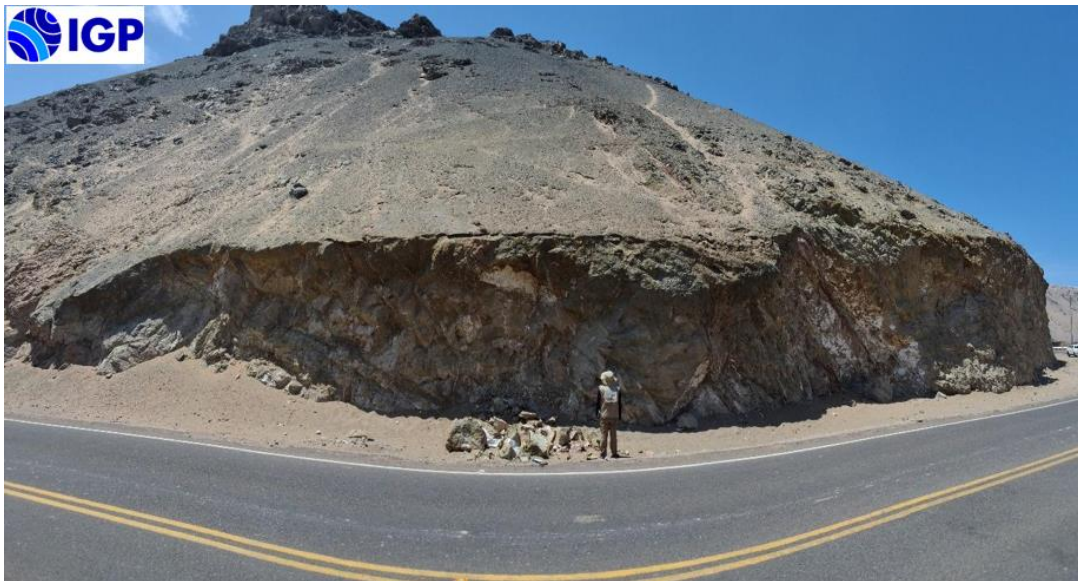
Figura 9: Súper Unidad Punta Coles, afloramiento de cuarzodioritas de meteorización alta cortada por venillas de cuarzo. La roca se llega a romper con 3 a 4 golpes con picota.
