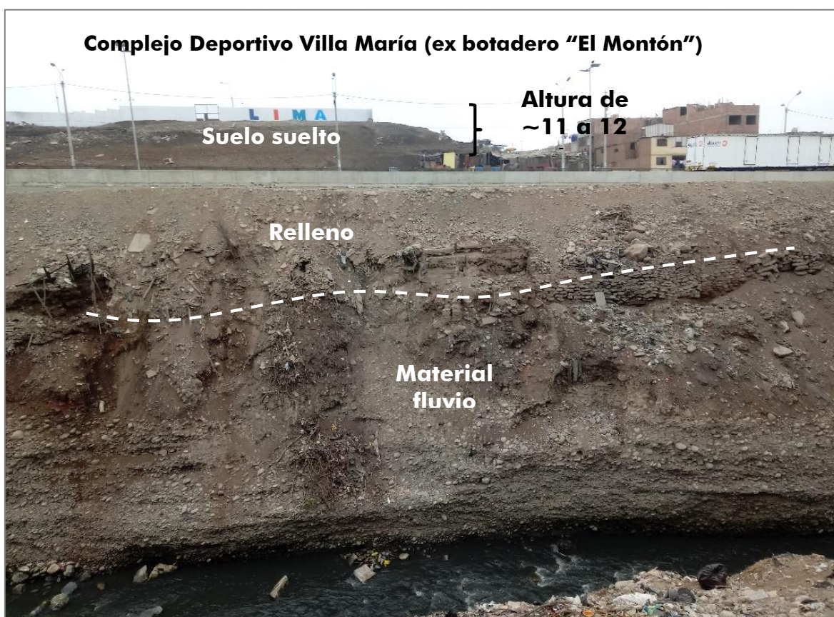
Figura 36. Imagen de suelo suelto identificado en el Complejo Deportivo Villa María (ex botadero “El Montón”).
