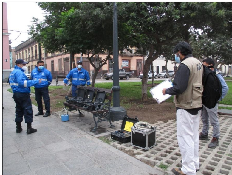
Figura 17. Equipo sísmico utilizado para el registro de vibraciones ambientales: sensor Lennartz (2N) y registradores CityShark II.
