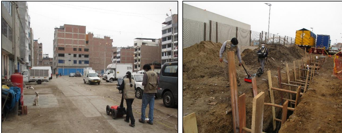
Figura 41. Disposición del georadar utilizando la antena de 350 MHz.
