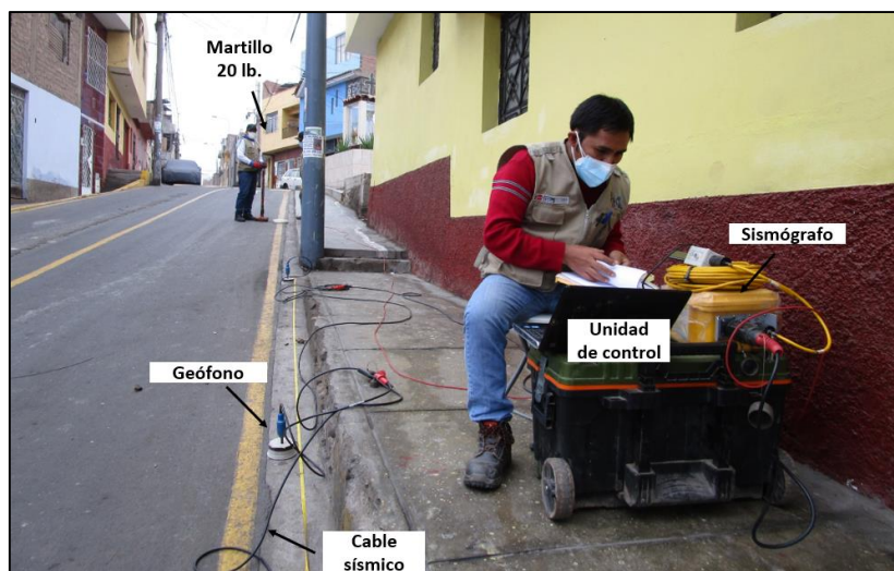
Figura 31. Equipos utilizados en la toma de datos por el método de MASW.
