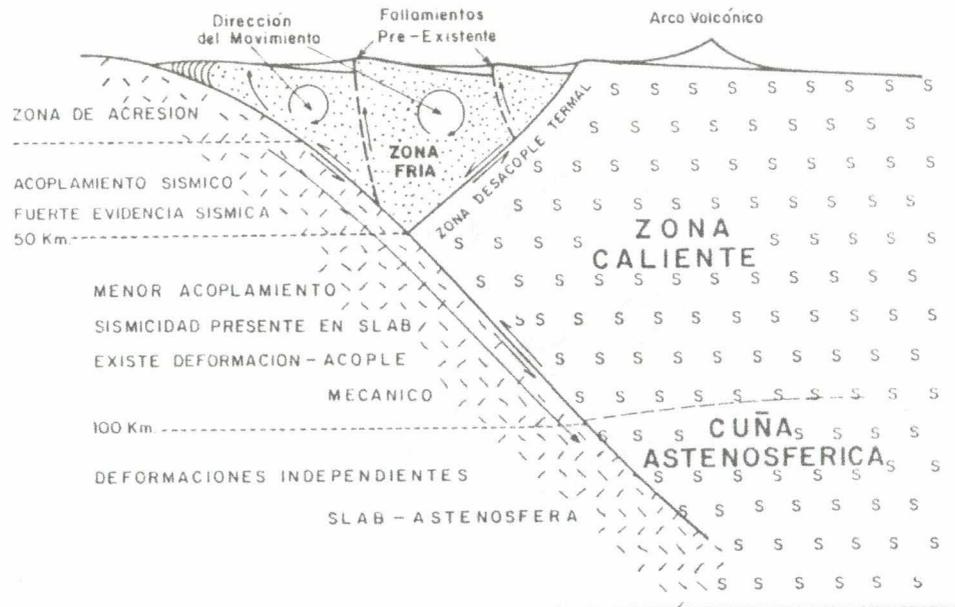
Figura 6. Esquema de la geometría del desacople termal presente en la región sur del Perú, según Rodríguez y Tavera (1991).
