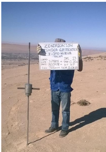
Figura 24: Ensayo de penetración dinámica ligera (DPL-13).
