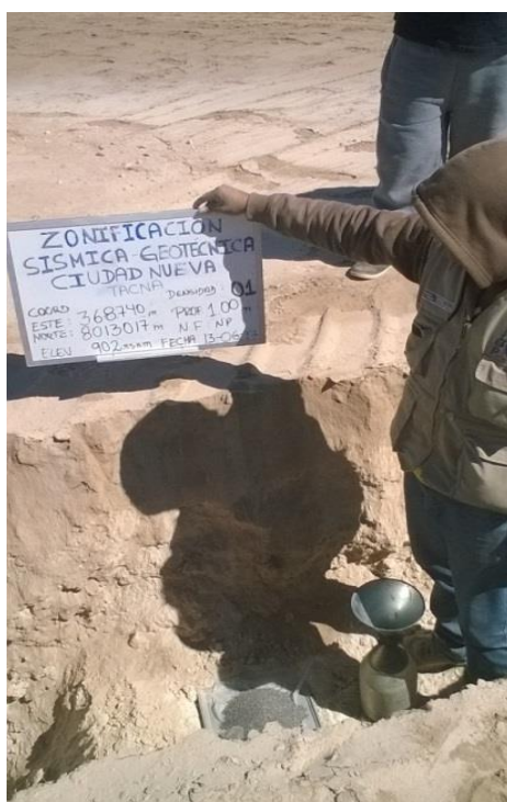
Figura 22: Ensayo de densidad del suelo in-situ en la calicata CN-01.
