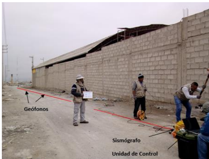
Figura 9: Equipos utilizados en la toma de datos de MASW en la Calle Raúl Jiménez.
