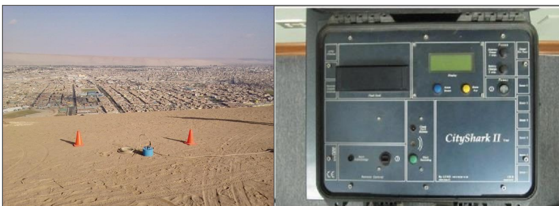
Figura 6: Equipo sísmico utilizado para el registro de vibraciones ambientales en Ciudad Nueva: sensores Lennartz (2N) y registrador CityShark II.
