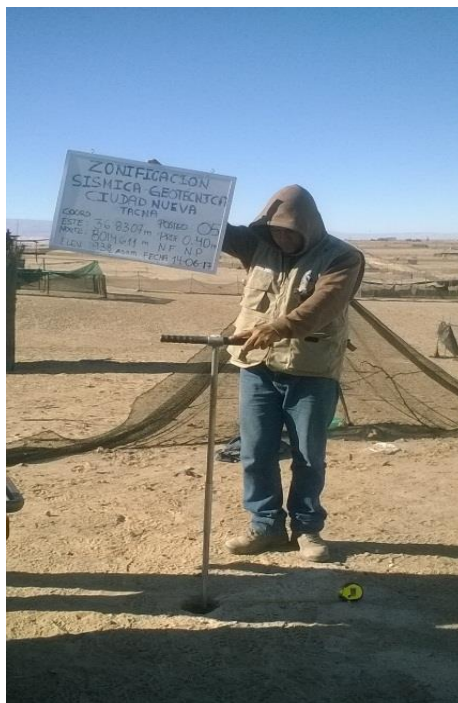
Figura 23: Ensayo con posteadora manual, realizado inmediaciones del sector Residentes de Quenuaru, ubicada a 1 km al este del Botadero Municipal.
