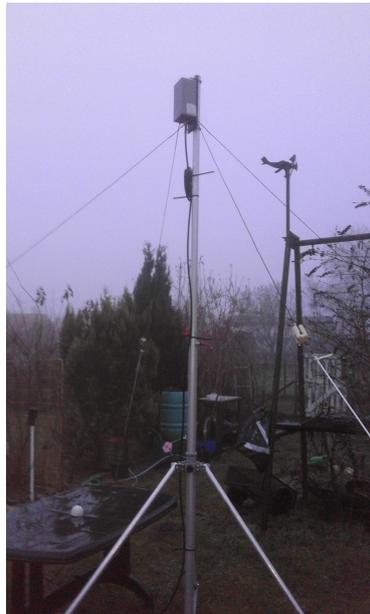
**Bild 3.4:** Eingesetzte Sendeantenne
