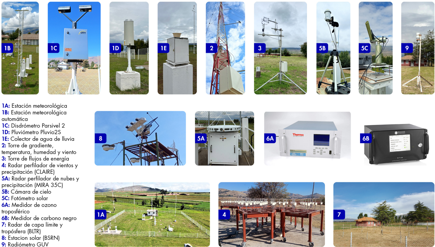
Figura 2. Algunos instrumentos y estaciones de LAMAR según la distribución presentada en la Figura 1.
