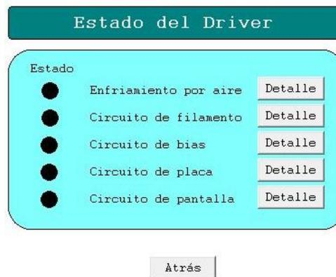
Figura 3.13: La lista de circuitos depende es muy similar para todas las etapas del transmisor, con excepción del PA, el cual tiene circuitos de enfriamiento por aire y por agua.
