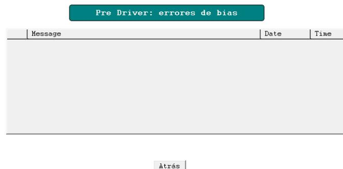
Figura 3.14: El detalle de los errores mostrará un mensaje en el que se incluirá el módulo y el circuito al que pertenece, así como la fecha y hora del incidente.
