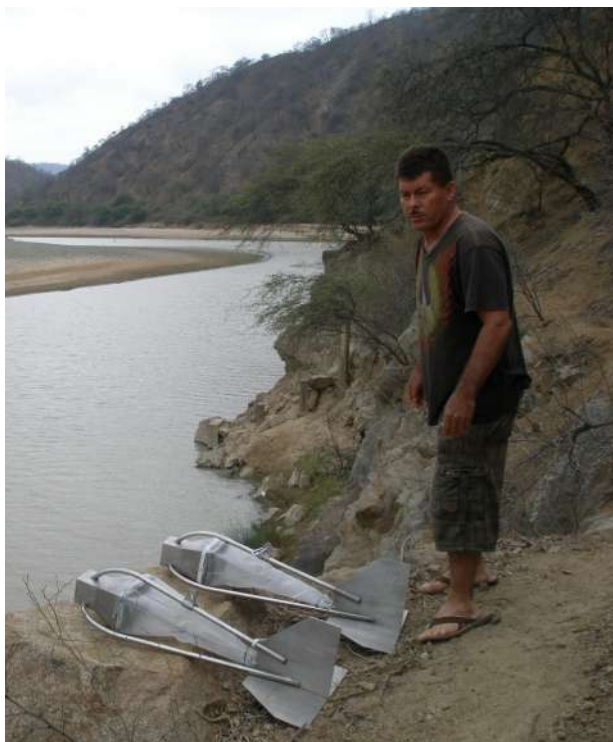
Muestreador de fondo Helley-Smith. El muestreador Helley-Smith está compuesto por un marco de acero, una malla de 0.2 mm elaborada de poliéster y boquilla.
