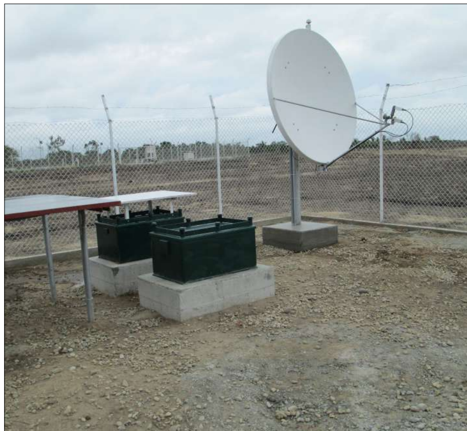
Las estaciones de Red Sísmica para la Alerta Temprana de Tsunami, instaladas a nivel nacional, nutren de información al SSN.
