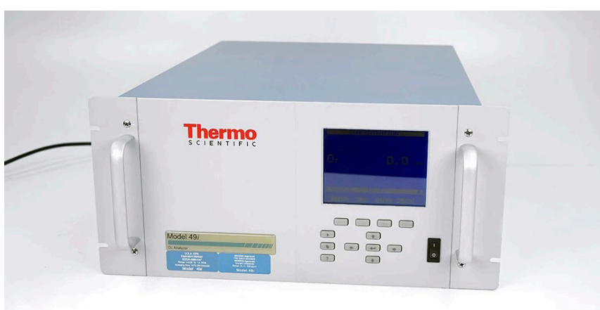
Figura 6. Medidor de ozono troposférico mediante la técnica de fotometría ultravioleta (UV), modelo 49i de marca Thermo Scientific (EE. UU.). Tomado de Thermo Sci.: https://www.thermofisher.com/order/catalog/product/49I
