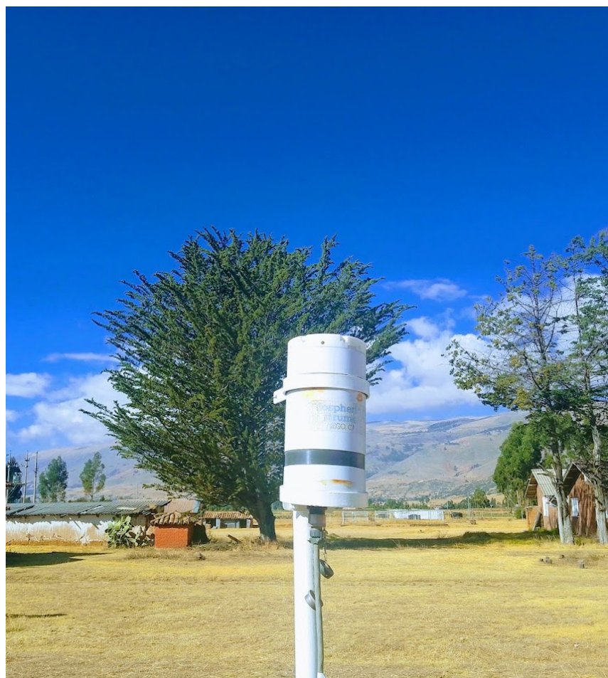
Figura 2. Radiómetro modelo GUV-511, de marca Biospherical, instalado en el Observatorio Geofísico de Huancayo del IGP.
