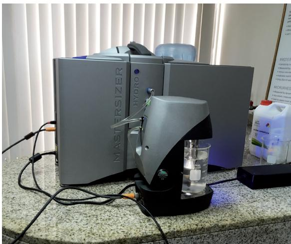
Granulómetro láser de laboratorio.
