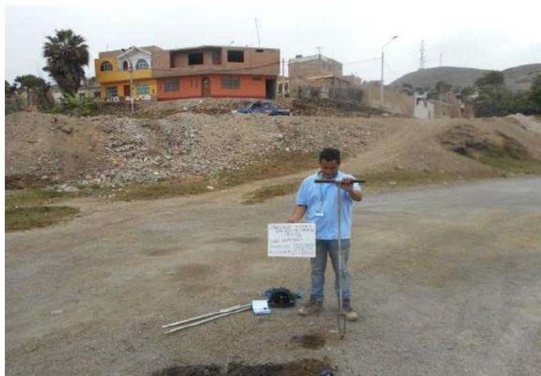
Figura 8: Posteadora y muestras obtenidas en suelos de Chancay
