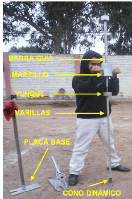
Figura 9: Equipos, accesorios y técnica de DPL
