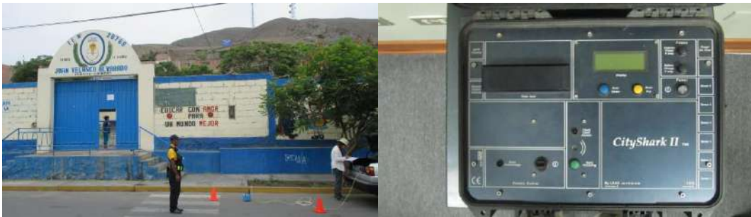
Figura 10: Equipo sísmico utilizado para el registro de vibraciones ambientales en Chancay: sensores Lennartz (2N) y registrador CityShark
