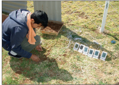
Campaña observacional para recopilación de datos en el Observatorio de Huayao. De izquierda a derecha: Foto 3.1 Ubicando el último resistor sobre la superficie del suelo. Foto 3.2 Ubicación del termistor a 50 cm de profundidad.
