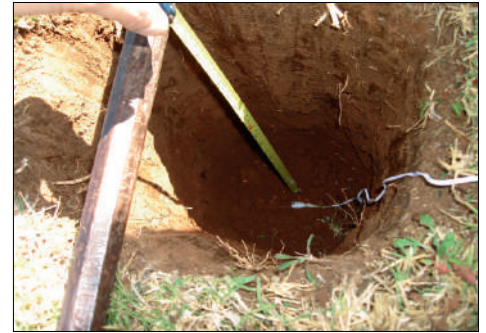
Campaña observacional para recopilación de datos en el Observatorio de Huayao. De izquierda a derecha: Foto 3.1 Ubicando el último resistor sobre la superficie del suelo. Foto 3.2 Ubicación del termistor a 50 cm de profundidad.
