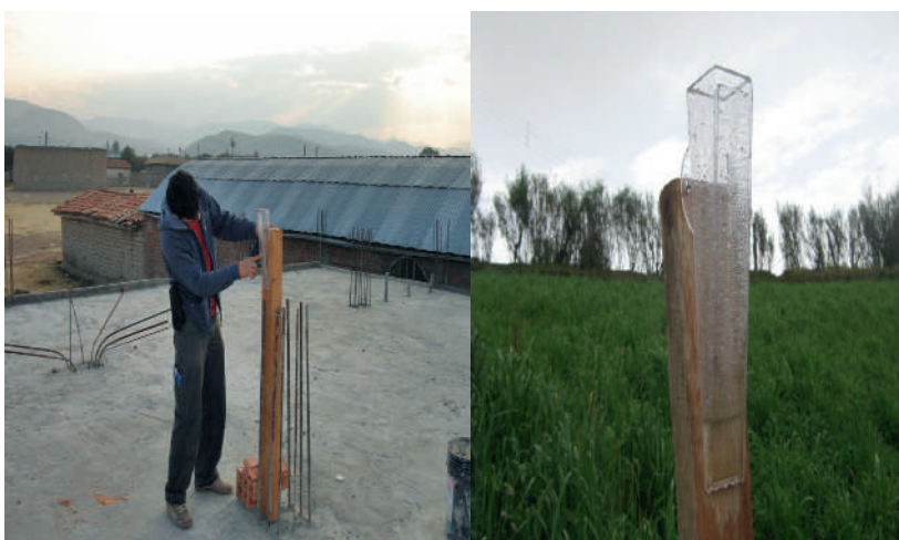
De izquierda a derecha: Fotos 4.2 y 4.3 Instalación y prueba de pluviómetro Crédito R. Orozco. Figura 4.9 Las planillas preparadas simulan graduación de los pluviómetros para facilitar la toma de datos.
