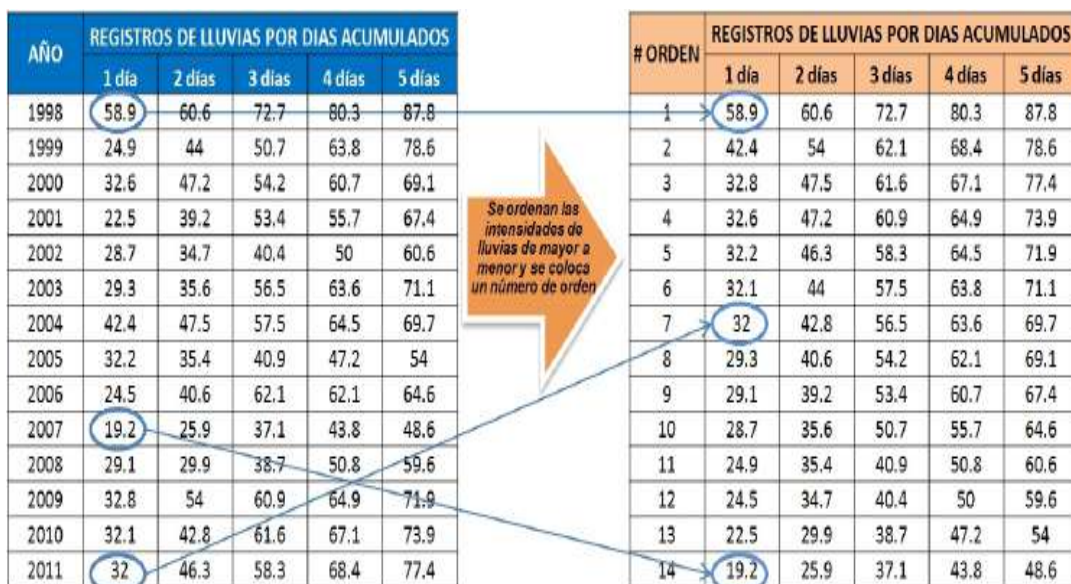
Figura 3.31 Acomodo de las intensidades máximas y selección de un número de orden.
