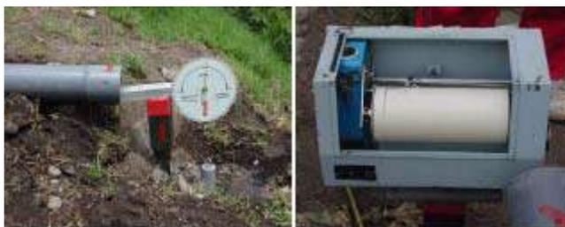
Figura 4. Dos tipos de extensómetros
