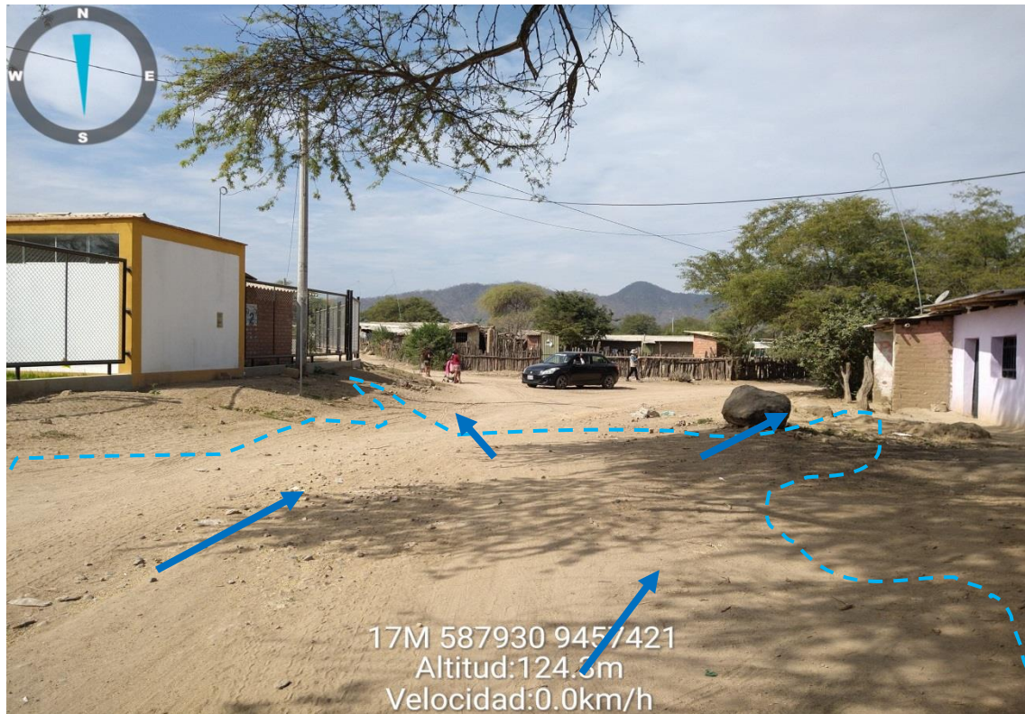
Figura 14.- Áreas afectadas (polígono celeste) por inundaciones pluviales (escorrentías superficiales) en épocas de precipitaciones, las flechas indican la dirección del flujo
