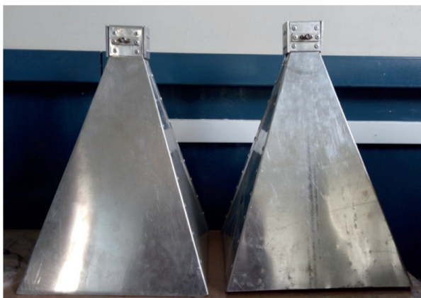
Figura 8. Antenas remachadas fabricadas en el Radio Observatorio de Jicamarca.
