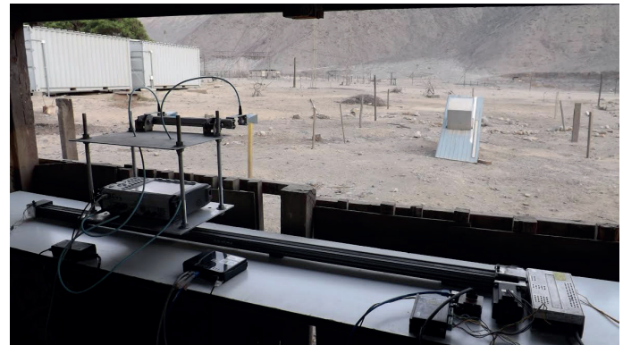
Figura 2. Sistema de Radar de Apertura Sintética implementado en el Radio Observatorio de Jicamarca.
