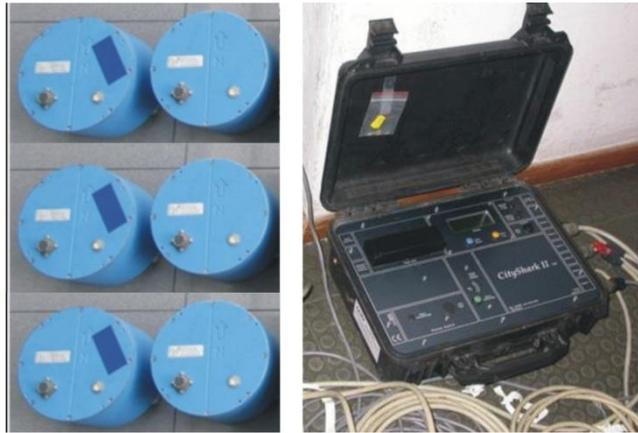
Figura 46 Equipo sísmico utilizado para el registro de vibración ambiental: sensores Lennartz (6N) y registrador CityShark de 18 canales.
