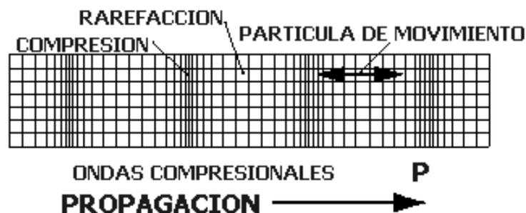
Figura 25 Movimiento longitudinal de las ondas P.
