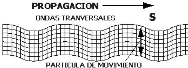
Figura 27 Movimiento transversal de las ondas S.
