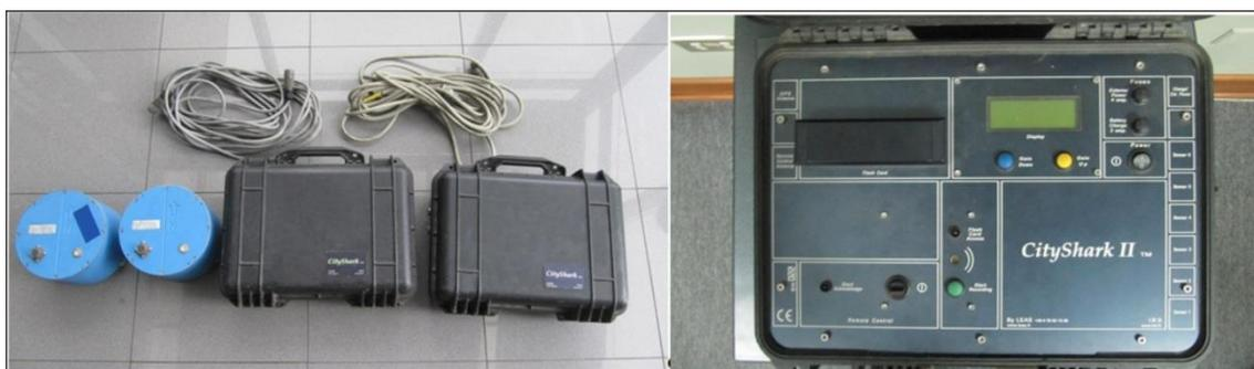
Figura 41 Equipo sísmico utilizado para el registro de vibración ambiental: sensores Lennartz (2N) y registrador CityShark.
