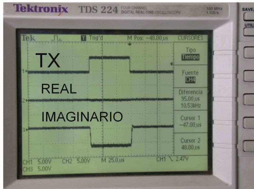
Figura 4.8. Imagen de la salida real e imaginaria del receptor
