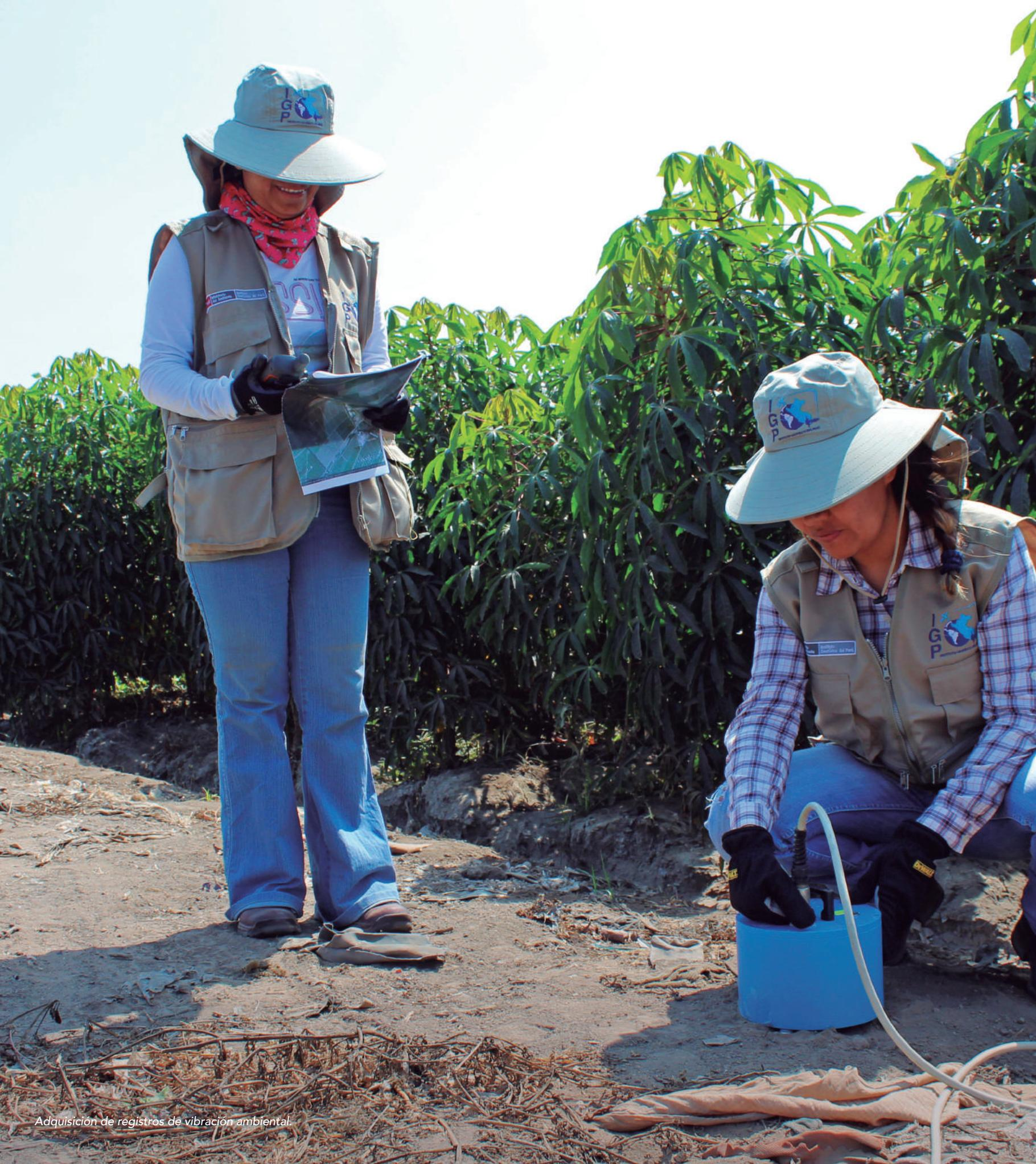
Adquisición de registros de vibración ambiental.
