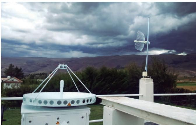
Radar MIRA 35C instalado en el Observatorio de Huancayo - IGP. Se encarga de medir parámetros microfísicos de las gotas de agua en la nube hasta los 11 km de altura.
