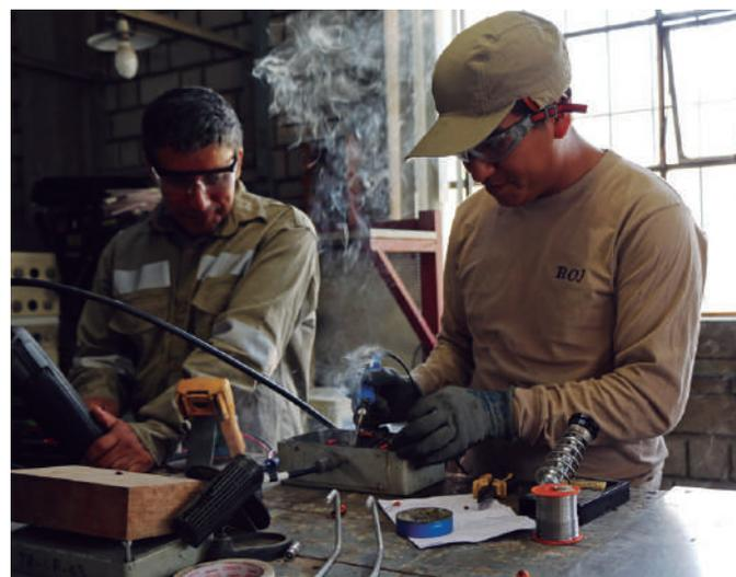
*Técnicos realizando trabajo de soldadura de dispositivos T/R los cuales son utilizados para la protección de sistemas de adquisición.*
