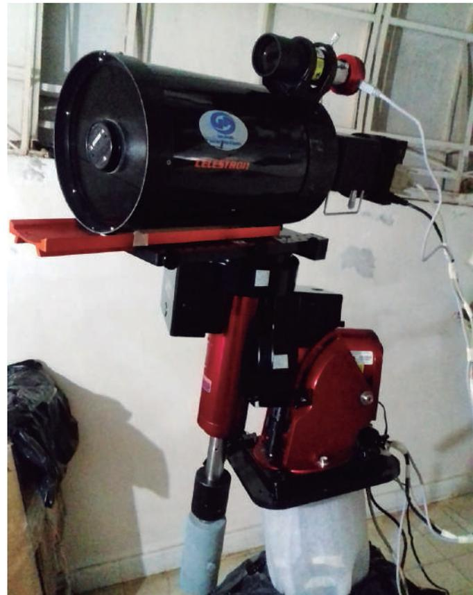
Configuración del prototipo para realizar espectroscopía astronómica dentro del convenio UNI-IGP. Se observa el espectrógrafo, adaptado a una cámara CCD junto a un telescopio reflector de ocho pulgadas.
