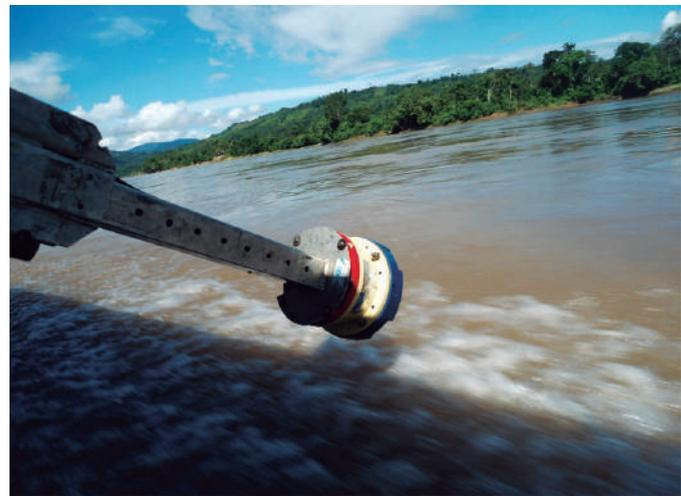
Perfilador acústico a efecto Doppler (ADCP), para medir caudales.
