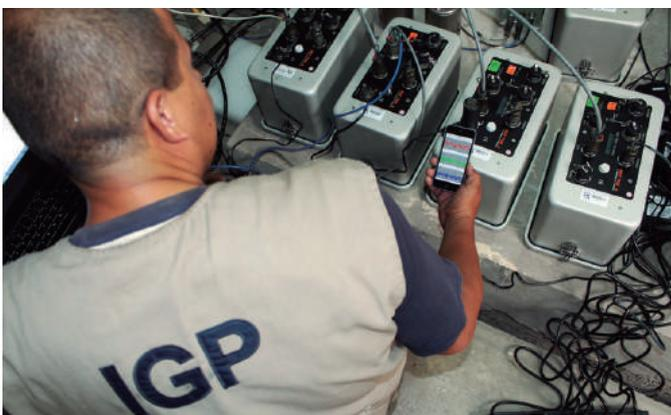
Prueba de equipos acelerómetros, se aprecia al Ing. Joel Gamarra revisando 04 acelerómetros Marca RefTek modelo 130 SMA usando tecnología inalámbrica Apple para observar la señal sensada por los instrumentos.
