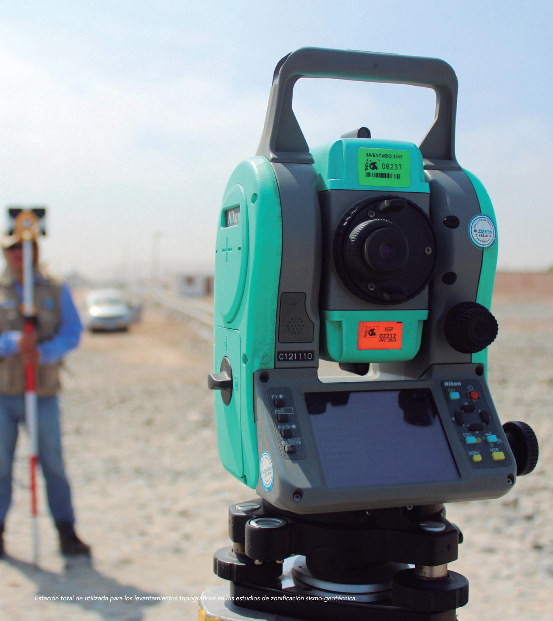
Estación total de utilizada para los levantamientos topográficos en los estudios de zonificación sismo-geotécnica.
