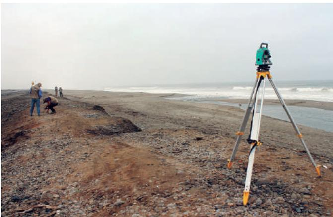
*Establecimiento de puntos de apoyo para el levantamiento topográfico en las zonas litorales del país, como parte de las actividades del PPR N° 068: Reducción de la vulnerabilidad y atención de emergencias por desastres.*
