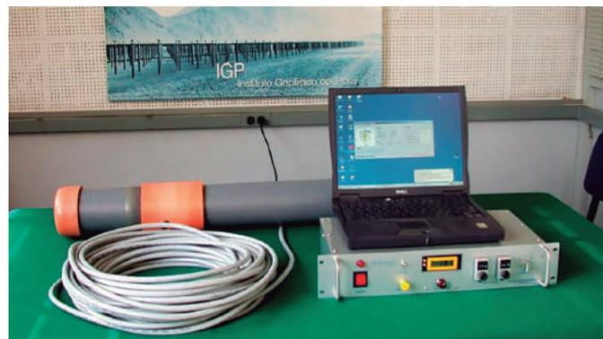
Magnetómetro fabricado por el personal del ROJ para el INPE.
