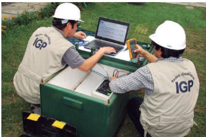
Mantenimiento de estación acelerométrica Stand Alone, se aprecia al Ing. Juan Carlos Oliva revisado un acelerómetro Marca RefTek modelo 130 SMA observando el estado de salud de la señal sensada.
