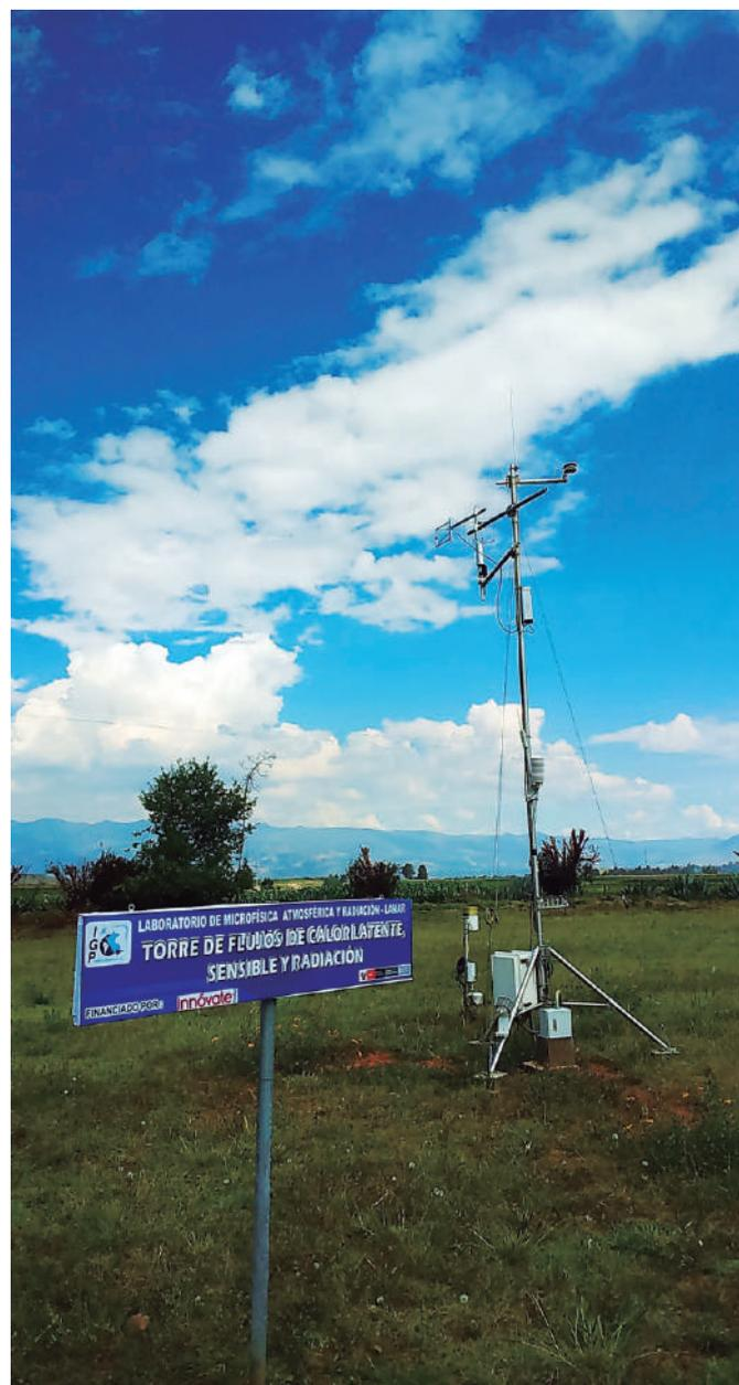
Conjunto de sensores de alta frecuencia que registran los flujos energía (calor sensible y latente) entre el suelo y la atmósfera. Ubicado en el Observatorio de Huancayo – IGP.
