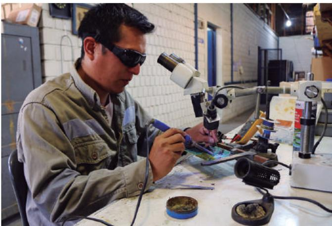
Técnico realizando ensamblaje de PCB principal para el instrumento controlador del radar.
