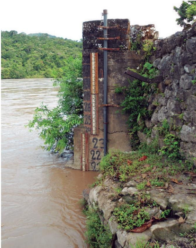
Regla de medición del nivel de río, estación Borja sobre el Río Marañón - Cuenca Alta.
