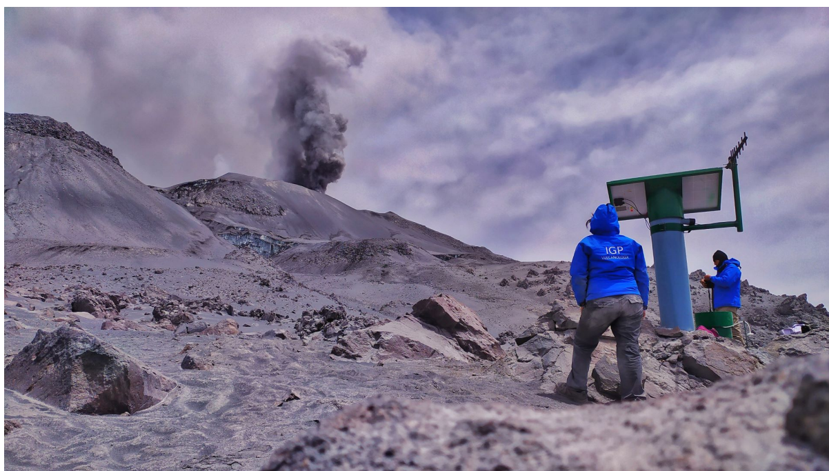
Estación multigas instalada en el volcán Sabancaya por el IGP en el marco de la implementación del CENVUL y la consolidación de redes de monitoreo.
