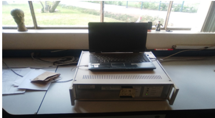
Figura 107: Sistema Receptor Analógico para la detección de TEC relativo y centelleos, Fuente: Elaboración propia
