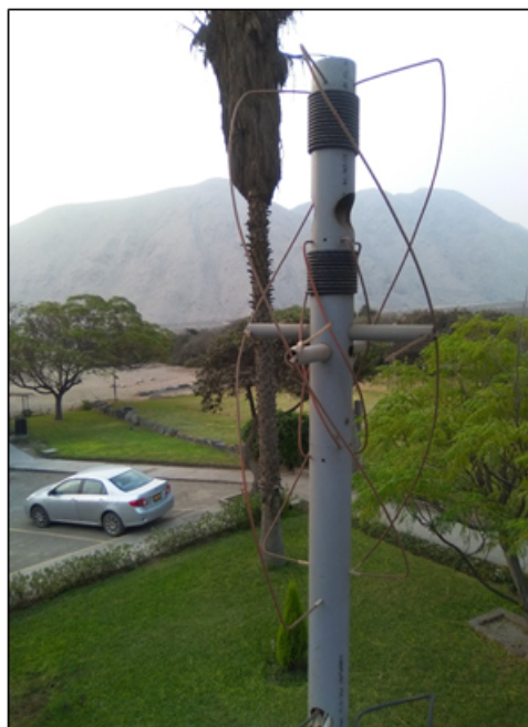
Figura 75: Ampliación de Antenas Quadrifilares Helicoidales, se puede apreciar como la antena de 400 MHz esta anidada dentro de la antena de 150 MHz, Fuente: Elaboración propia
