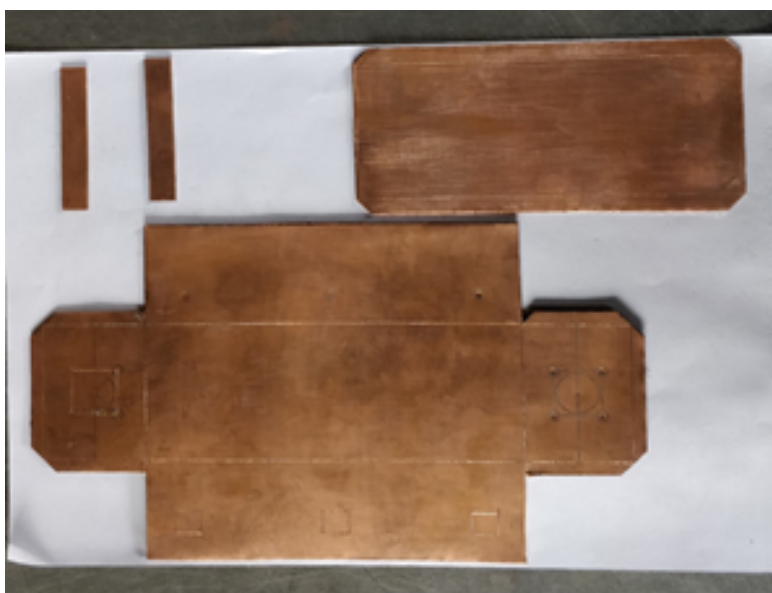
Figura E6: Cortado de láminas de la cavidad resonante, Fuente : Elaboración Propia
