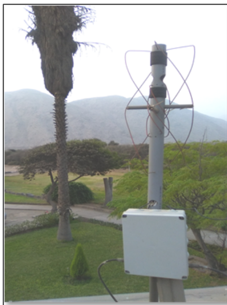
Figura 74: Antenas Quadrifilares Helicoidales, con caja de preAmplificadores y Filtros Pa-saBanda, Fuente: Elaboración propia
