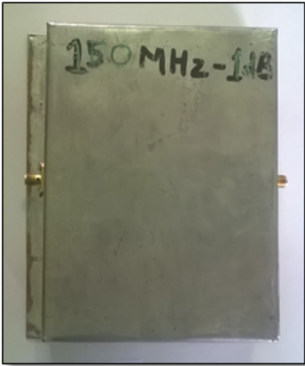
Figura 83: Filtro Pasa Banda 150MHz@Spam 60 MHz, Fuente: Elaboración propia
