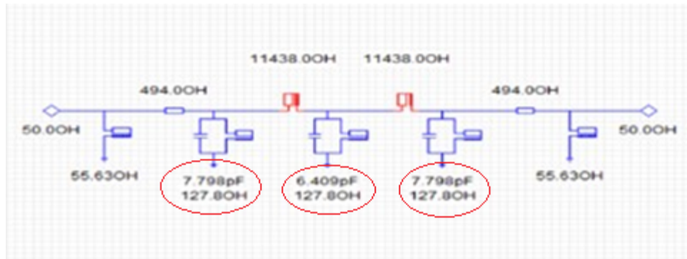
Figura E2: Resultados del diseño de los filtros resonadores mediante el software Ansoft SV, en este modelo se puede apreciar los valores de los condensadores que varían entre 6 y 8 pF, Fuente : Elaboración Propia
