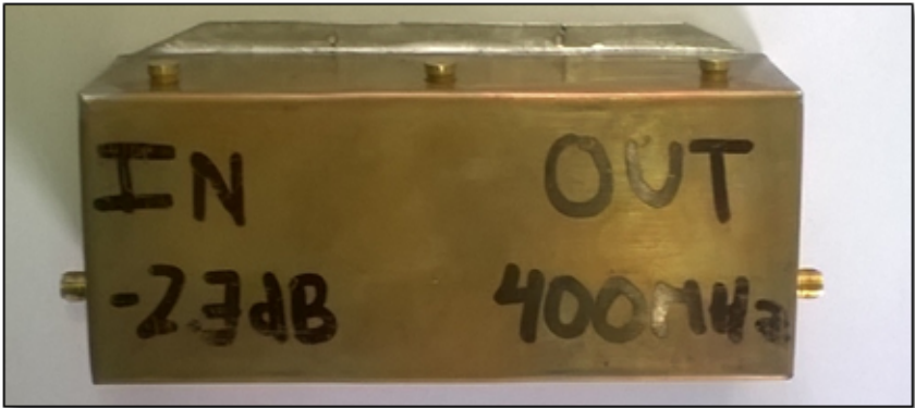
Figura 86: Filtro Pasa Banda 400MHz, Fuente: Elaboración propia
