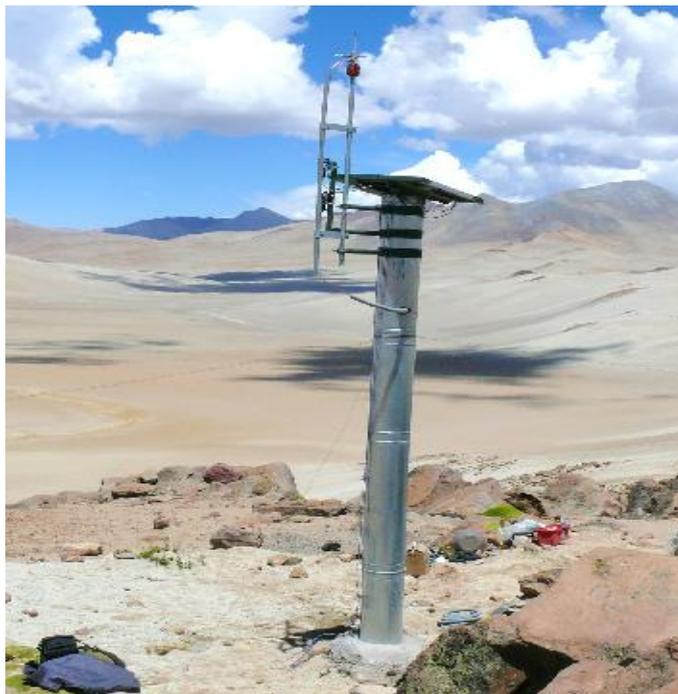
Figura 10.- Estación sísmica telemétrica para el monitoreo en tiempo real del volcán Ticsani.
