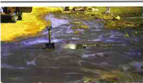
Figura 7. Volcanes de arena (sand boil), en Boca del Tucuyo, en la tormenta sísmica ocurrida entre el 30 de abril y 4 de mayo de 1989. Fuente: De Santis y Beltrán (1990).
