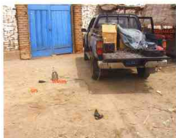
Figura 3. En el extremo superior de la figura se muestra la disposición del sistema de registro: sensor, GPS y registrador. En el extremo inferior, un ejemplo de los registros de Vibración Ambiental en sus tres componentes obtenido en cada punto (GT11: componente vertical; GT12: componente NS; GT13: componente EO).
