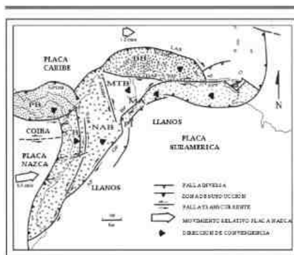
Figura 1. Geodinámica general simplificada entre las placas Caribe, Suramérica y Nazca. Equivalencias usadas: Bonaire (BB), Chocó (CB), Maracaibo (MTB), Norte Andino (NAB) y Panamá (PB). Zonas: Andes de Mérida (MA) y Pamplona (PI). Algunas de las mayores fallas reportadas: Algeciras (AF), Boconó (BF), El Pilar (EPF), Gualcaramo (GF), Romeral (RFS), Santa Marta-Bucaramanga (SMBF), San Sebastián (SSF) y Oca-Ancón (OAF). Otros rasgos estructurales: Subducción de las Antillas menores (LAS), Cañón Los Roques (LRC), deformación al norte de Panamá (NPDB) deformación al sur del Caribe (SCDB).
