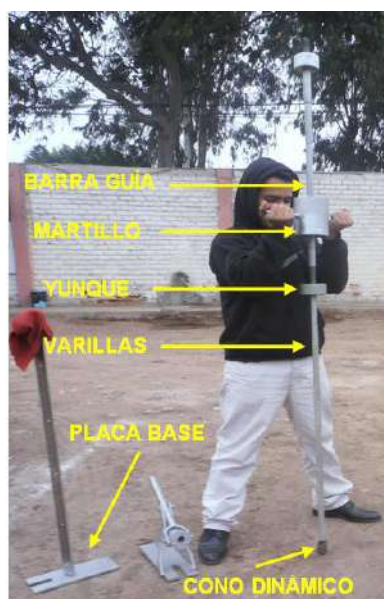
Figura 8: Equipos, accesorios y técnica de DPL
