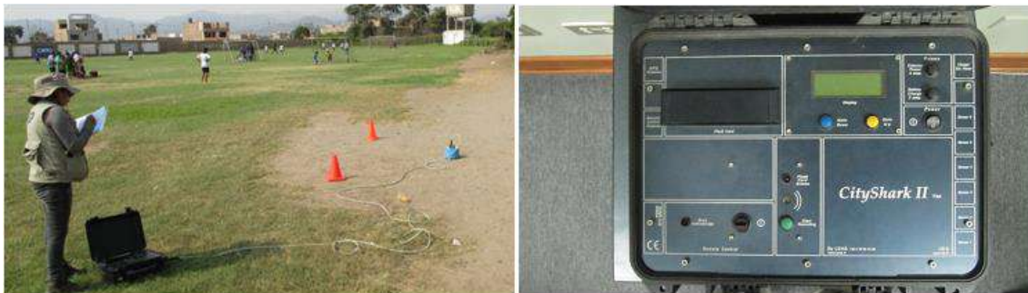
Figura 9: Equipo sísmico utilizado para el registro de vibraciones ambientales en Huaral: sensores Lennartz (2N) y registrador CitySharp
