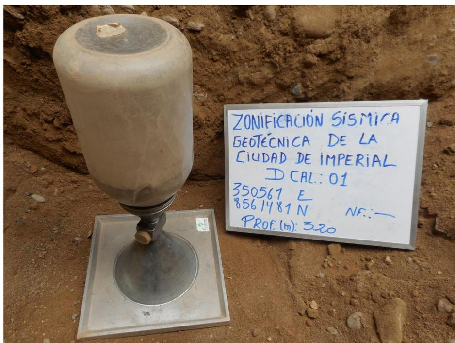
Figura 25: Ensayo de densidad de campo, a través del método del cono de arena, realizado en la calicata C-01 a 3.20 m de profundidad.
