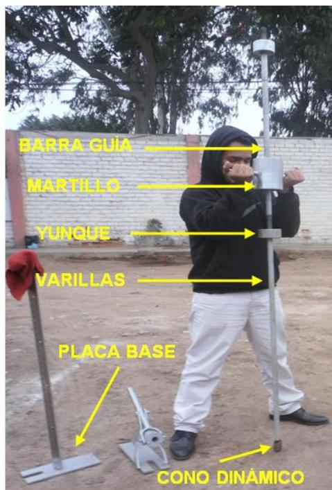
Figura 27: Equipo y accesorios que conforman el DPL.
