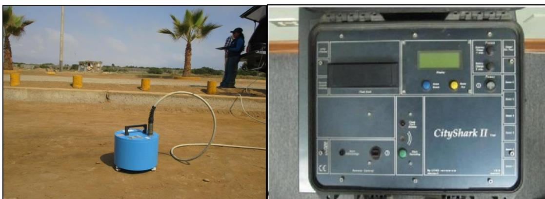
Figura 5: Equipo sísmico utilizado para el registro de vibraciones ambientales en Imperial: sensor Lennartz (2N) y registradores CityShark II.
