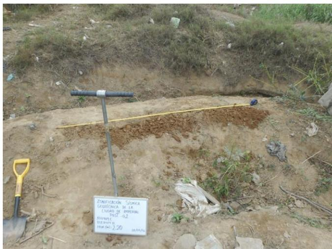
Figura 26: Posteo P-02 realizado en la margen derecha de la carretera hacia San Benito, la profundidad alcanzada fue de 2.20 m.
