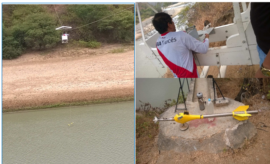
Figura 28 Aforo con Molinete. Estación El Tigre. Cuenca Puyango-Tumbes
