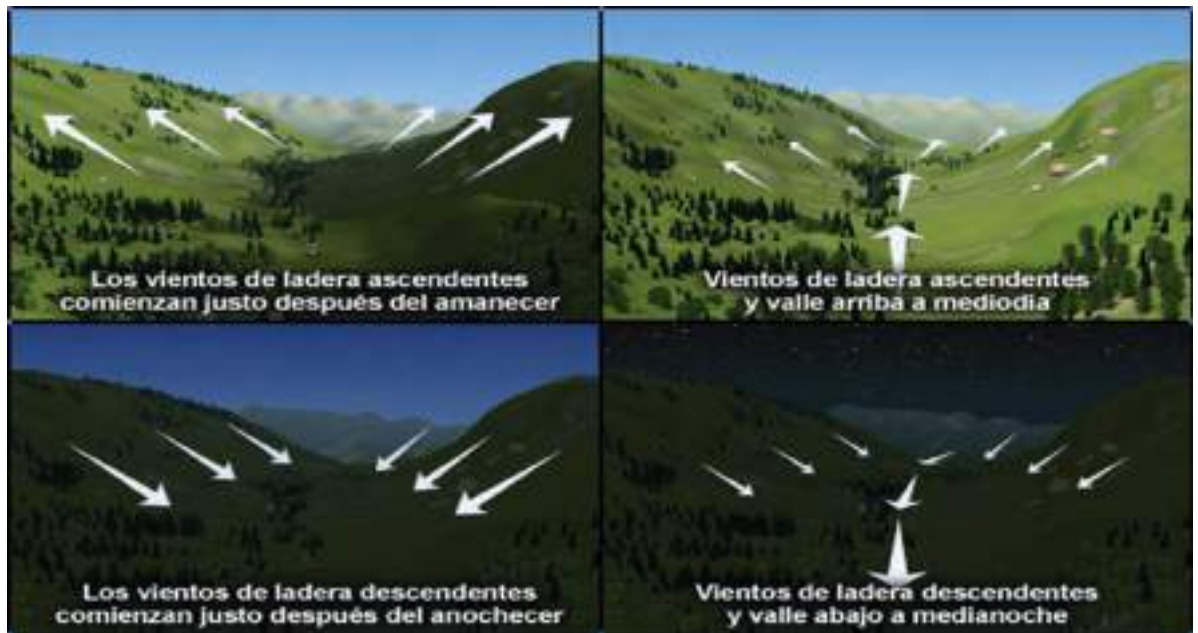
Figura 1. Viento generado por el gradiente térmico (fuente: http://www.medted.ucar.edu ).
