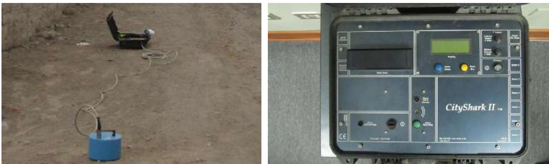
Figura 6: Equipo sísmico utilizado para el registro de vibraciones ambientales: sensores Lennartz (2N) y registrador CityShark
