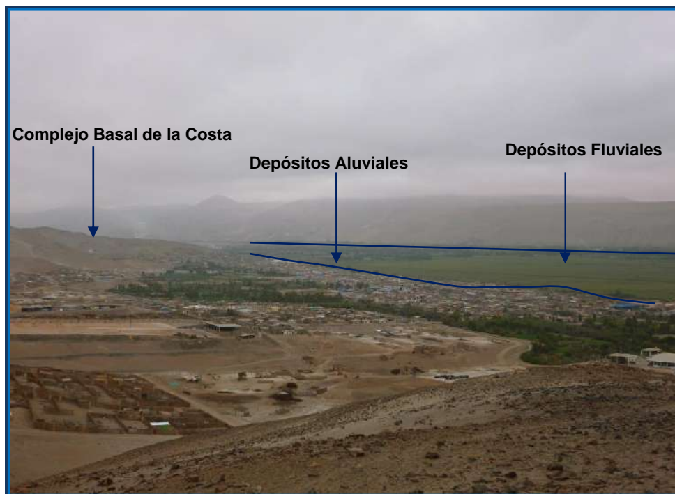
Figura 40: La ciudad de Cochachaca está asentada sobre depósitos aluviales limitados por el Complejo Basal de la Costa y por depósitos fluviales.
