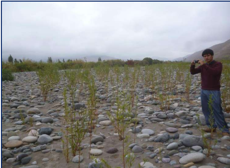
Figura 26: En el lecho fluvial está compuesto por gravas subredondeadas en matriz arenosa de grano fino a medio
