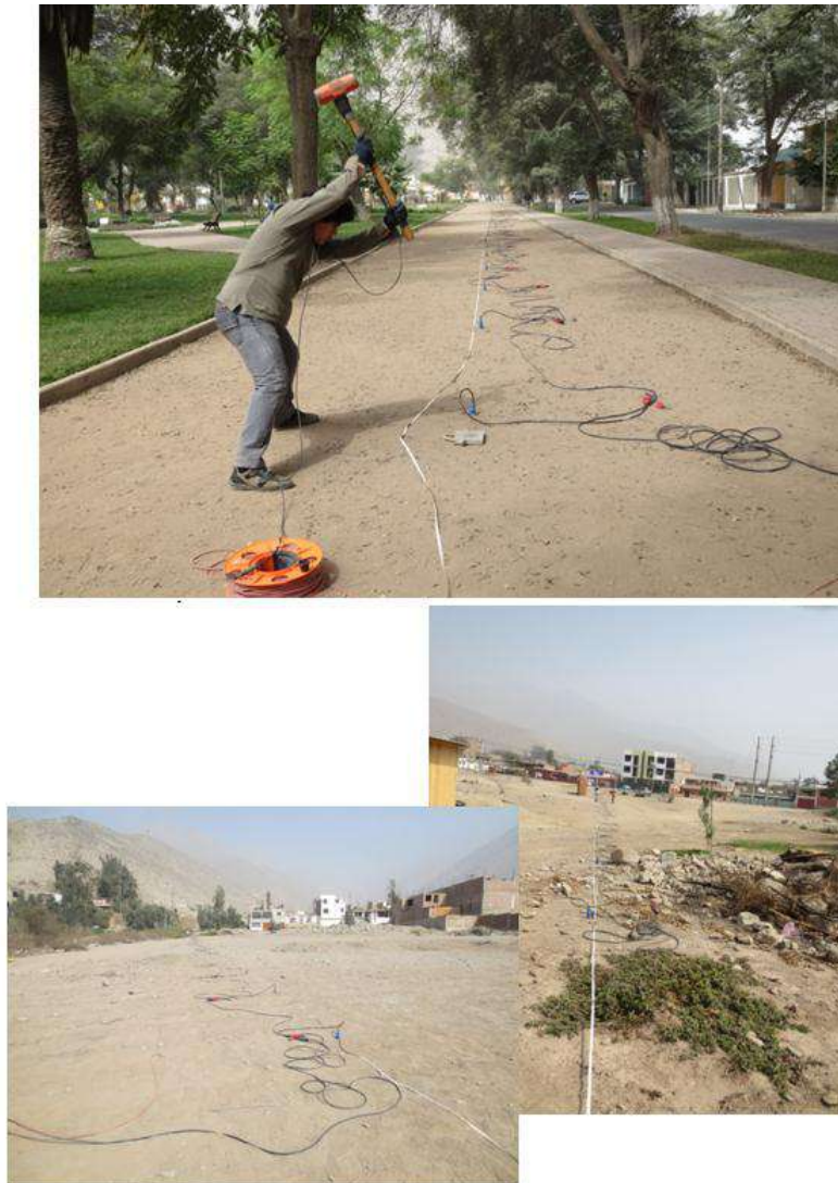
Figura 45: Imágenes de la disposición del equipo de refracción sísmica para la toma de data
