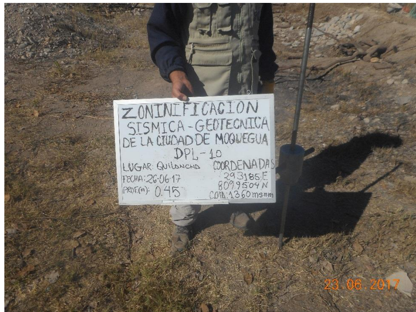
Figura 33: Ejemplo de ensayo de penetración dinámica ligera (DPL-10).
