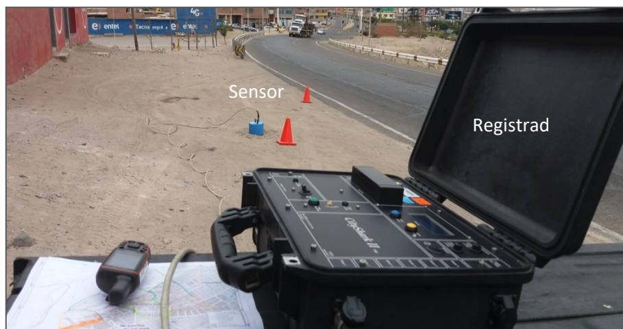
Figura 6: Equipo sísmico utilizado para el registro de vibraciones ambientales en la ciudad de Moquegua: sensor Lennartz (2N) y registradores CityShark II.
