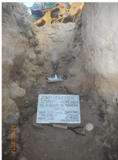
Figura 31: Ejemplo de Calicata CM-06, Ubicada en el sector Poder Judicial de Moquegua.
