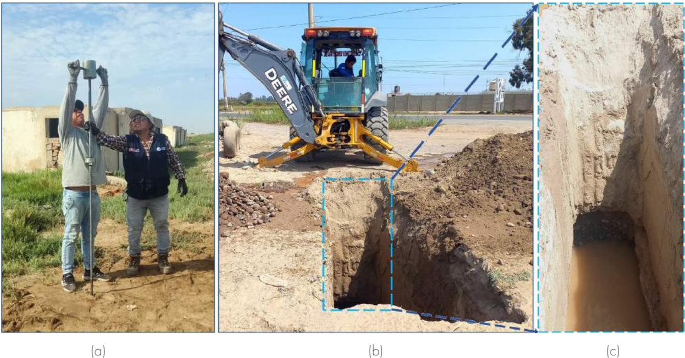
**Figura 1.** a) Equipo de Penetración Dinámica Ligera (DPL). Sector Boca de Río, Pisco Playa Sur. b) Calicata CA-03, sector Pampa de Ocas, distrito de San Andrés. c) Calicata CA-03, donde se observa el nivel freático a 2.50 m de profundidad y la composición de suelos con alto potencial de licuación. Créditos: IGP.
