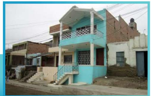
Figura 3.8: Vivienda de material noble con tres pisos, ubicada en el sector de Puerto Chico. Tiene alrededor de 15 años de construida y aparentemente se encuentra en buen estado; sin embargo, presenta un frente con aleros amplios soportados con columnas que podría ser vulnerable ante un evento sísmico.
