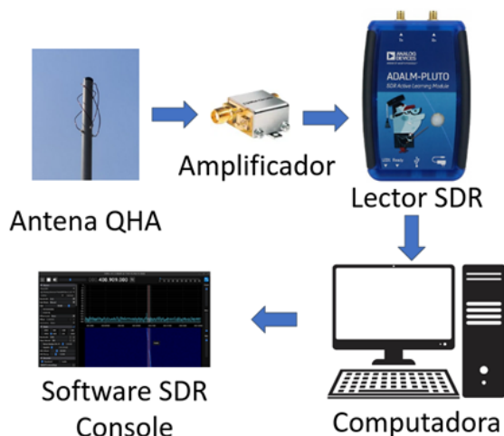
Figura 7. Arreglo experimental para la recepción del satélite COSMIC-2.
