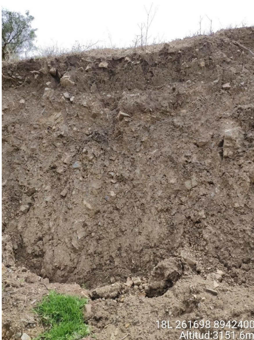
Figura 6. Perfil estratigráfico del depósito aluvial ubicado en el extremo occidental del área de estudio.
