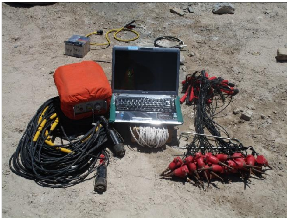
Figura 28. Equipos utilizados en la toma de datos por el método de MASW.
