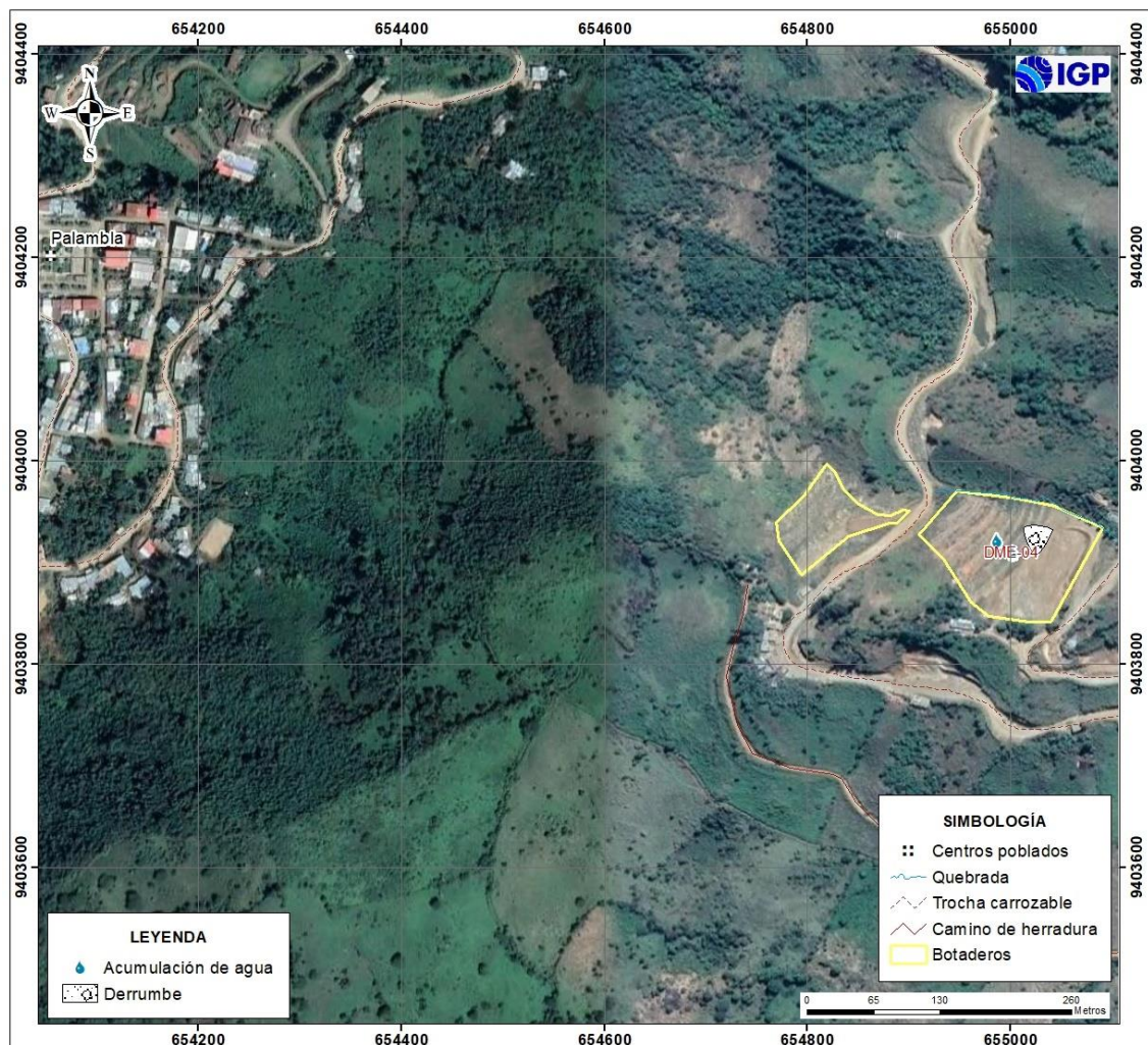
Figura 27.- Derrumbe o caída de suelos identificado en la plataforma del DEM 04
