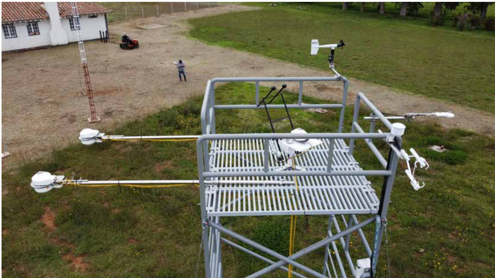
Figura 2. Sistema Eddy Covariance para la medición de flujos de vapor de agua ( H_2O ) y dióxido de carbono ( CO_2 ), instalado en el Observatorio Geofísico de Huancayo del IGP.
