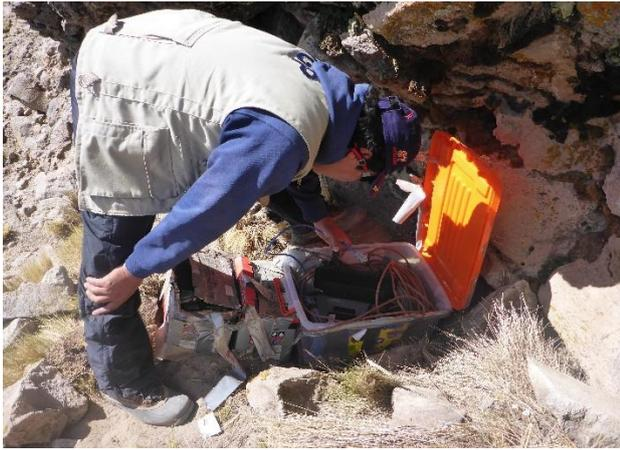
*Figura 4.8 Instalación de los equipos sísmicos de la estación TCN (izquierda).*
