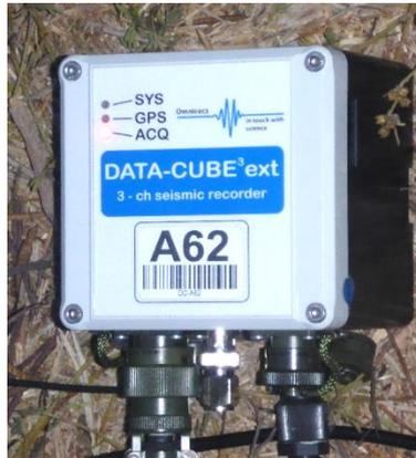
Figura 4.3 Imagen del registrador Data – Cube3 utilizado en la estación SOQ.
