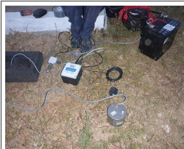
*Figura 4.6 Estación SOQ con el registrador CUBE3, su sensor Lennartz a modo de prueba.*
