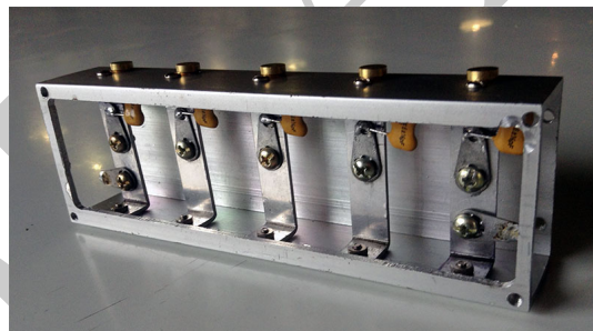
Figura 3.13: Filtro combine de cinco elementos con varillas de cobre que opera a 445 MHz. Se utilizó un perfil de aluminio como soporte.
