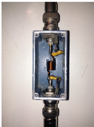
Figura 3.19: Filtro pasabajo tipo \pi basado en una bobina y dos capacitores de alto Q.
