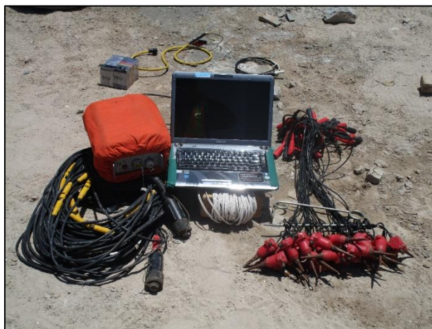
Figura 26. Equipos utilizados en la toma de datos por el método de MASW.
