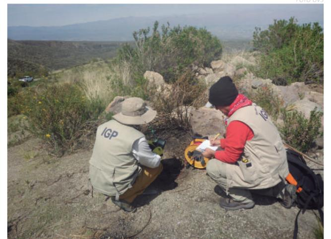
Figura 03.- Especialistas del OVS realizaron mediciones del Potencial Espontáneo en una línea de trabajo de más de 5 km de longitud en el volcán Misti.
