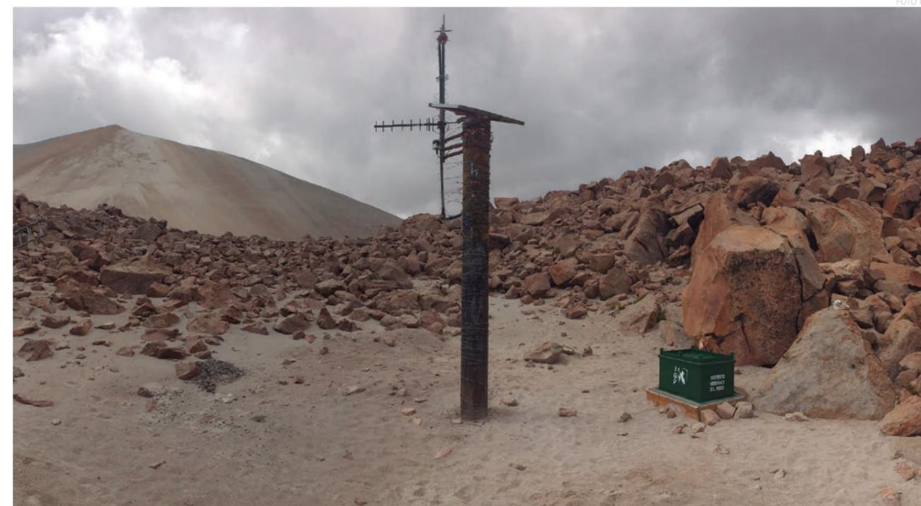
Figura 07.- Estación sísmica telemétrica TCN, emplazada en el domo reciente del volcán Ticsani. Esta es una de las 4 estaciones que componen la red local que monitorea la actividad de este volcán ubicado en la región Moquegua.
