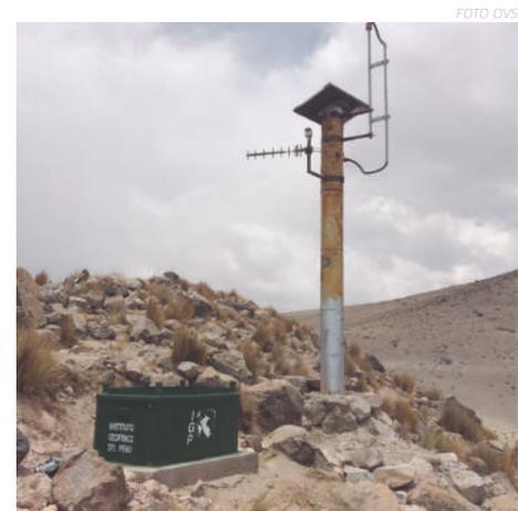
Figura 08.- Estación sísmica telemétrica MUYQ, ubicada a 13 km al noroeste del domo reciente del volcán Ticsani. Esta es una de las cuatro estaciones que componen la red de monitoreo local que vigila el comportamiento de este volcán.
