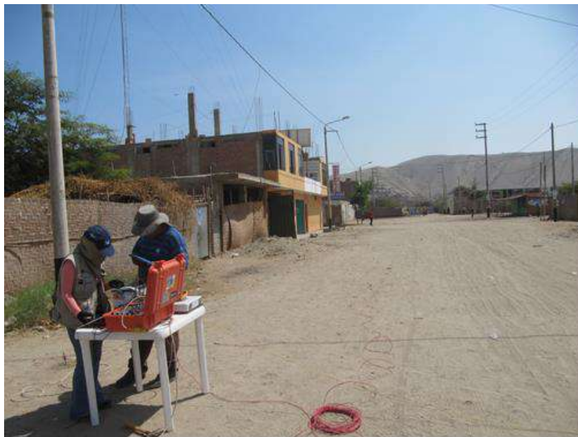
Figura 11: Disposición del equipo de prospección eléctrica en la ciudad de Casma
