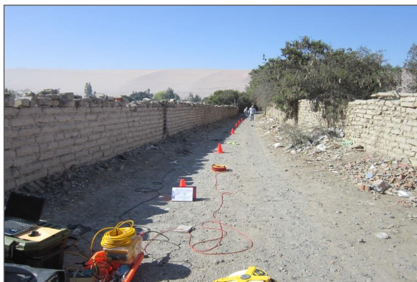
Figura 9: Equipo sísmico para la toma de datos de MASW en la Asoc. Taller Binacional.
