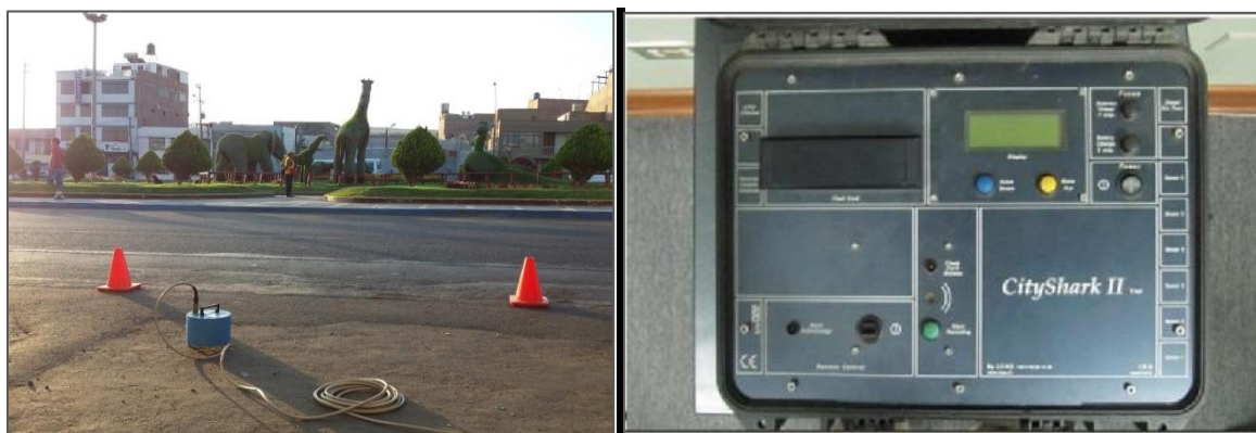
Figura 6: Equipo sísmico utilizado para el registro de vibraciones ambientales en Tacna: sensor Lennartz (2N) y registrador CityShark II.
