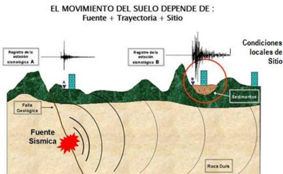
Figura 5: Las condiciones locales de sitio controlan la amplificación del sacudimiento del suelo, puesto en evidencia con la amplitud del registro sísmico obtenido sobre roca y sedimentos.
