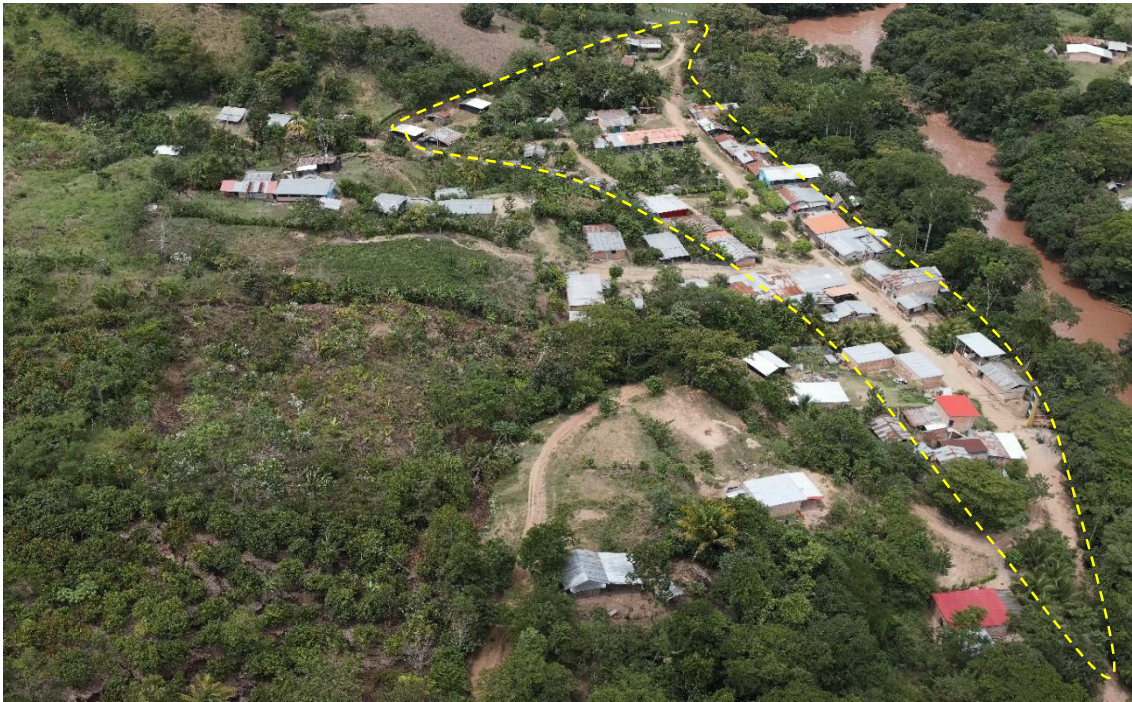
Figura 5.- Unidad geomorfológica llanura aluvial (polígono amarillo delimitado con una línea discontinua) que presenta relieve llano de pendientes inferiores a los 5.00^\circ de inclinación y sobre la cual se asienta la mayor parte de las viviendas del caserío Eladio Tapullima
