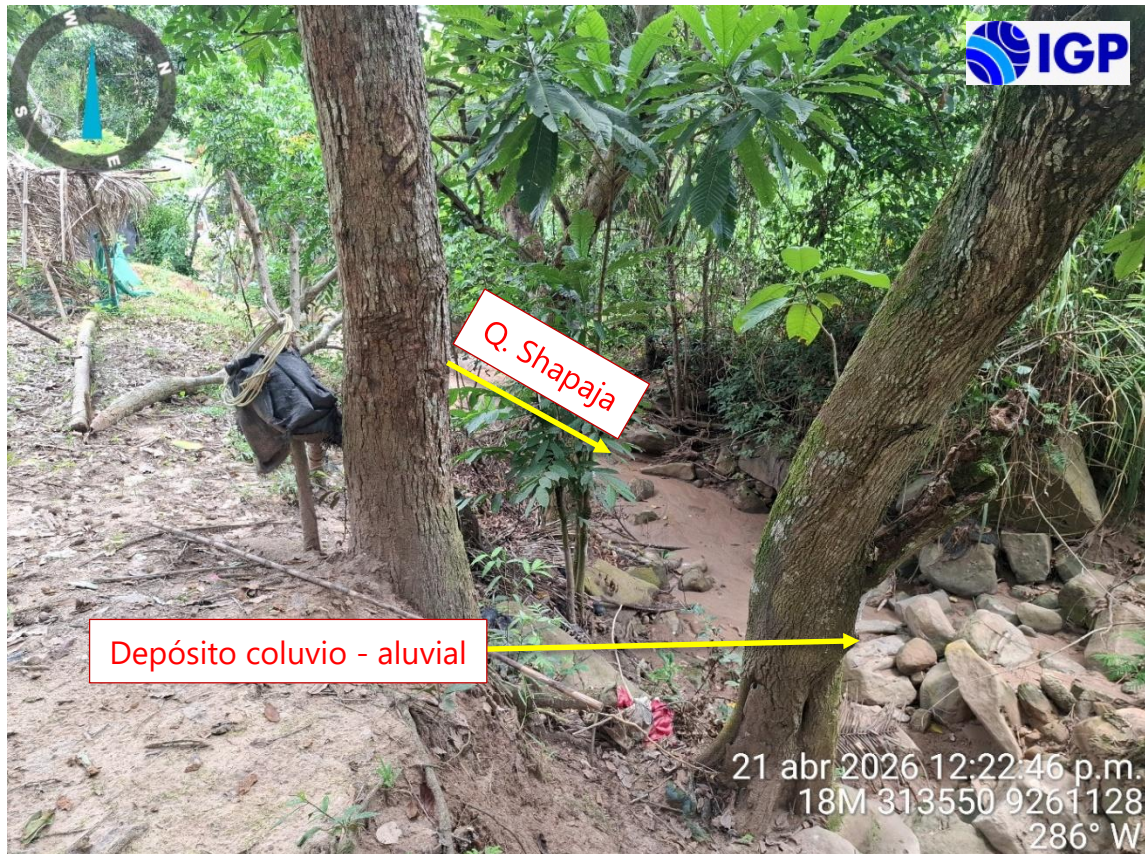
Figura 17.- Depósito coluvio – aluvial conformado por material heterogéneo (bloques de roca, gravas y arenas) transportado a través del cauce de la quebrada Shapaja
