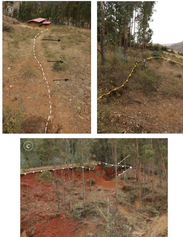
**Figura 11.** a) Agrietamiento con dirección Noreste, a pocos metros del colegio, en dirección a la quebrada estacional de Corisorgona; b) Escarpe de deslizamiento activo, a 114 m, al noreste de la Institución Educativa de Corisorgona; c) Deslizamiento en capas arcillosas rojas en las laderas de Corisorgona.
