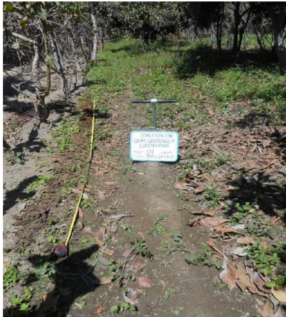
Figura 6: Posteadora y muestras obtenidas en suelos de Lunahuaná
