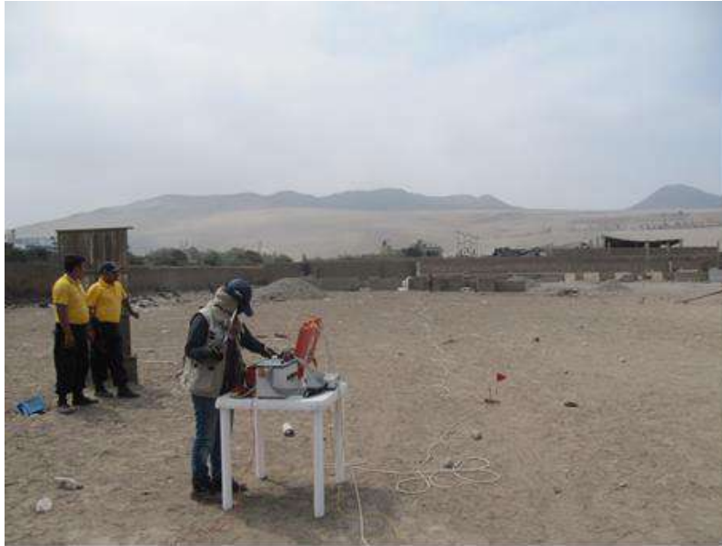
Figura 12: Disposición del equipo de prospección eléctrica en la ciudad de Lunahuaná
