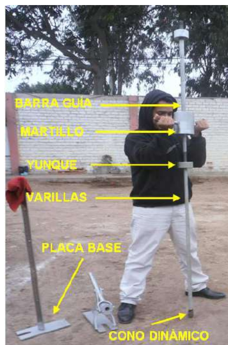
Figura 7: Equipos, accesorios y técnica de DPL
