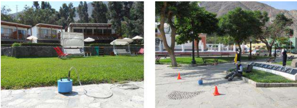
Figura 8: Equipo sísmico utilizado para el registro de vibraciones ambientales en Lunahuaná: sensores Lennartz (2N) y registrador CityShark
