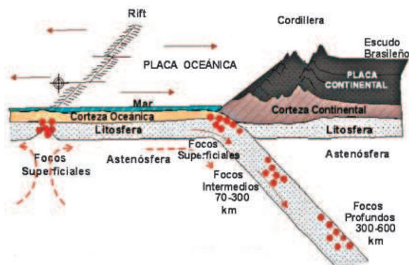
Figura 2. Esquema que muestra el proceso de expansión de los fondos oceánicos (rifts) y la convergencia de placas (oceánica vs. continental) con la formación de la Cordillera Andina. Las flechas indican la dirección de las corrientes de convección.
